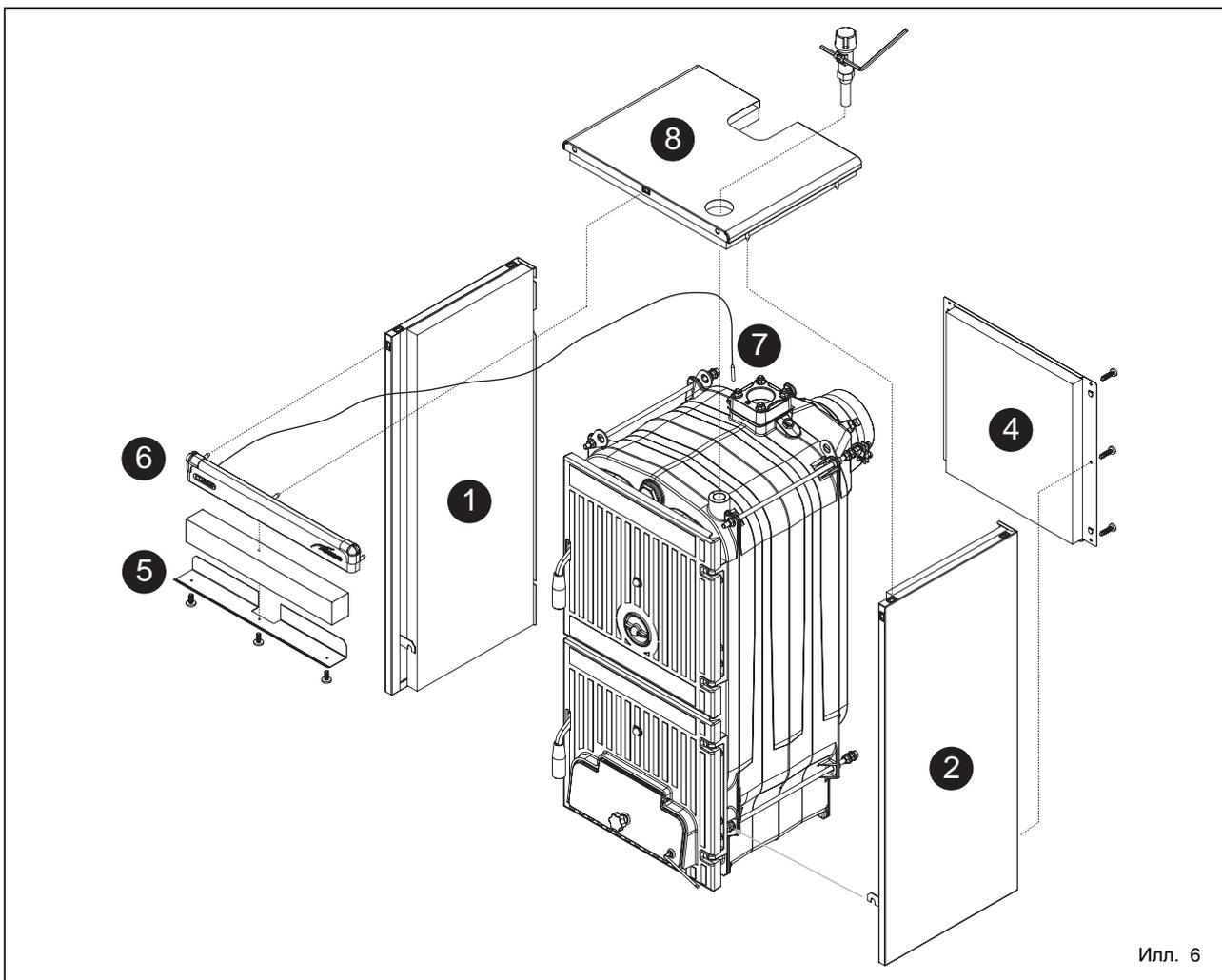
правильной установки боковин кожуха. На нижних тягах, как спереди, так и сзади, котла, привинчены 2 гайки, одна из которых служит для блокировки опорных скоб боковин. Установка компонентов кожуха должна выполняться следующим образом:
